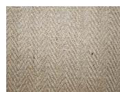
Le cinghie di juta sono strisce di tessuto sottili, armate con tela in filato di juta, per l'imbottitura di sedute e schienali. Determinante per la qualità delle cinghie è il tipo di filato ritorto per l'ordito (doppio o triplo) e lo spessore dei fili.
